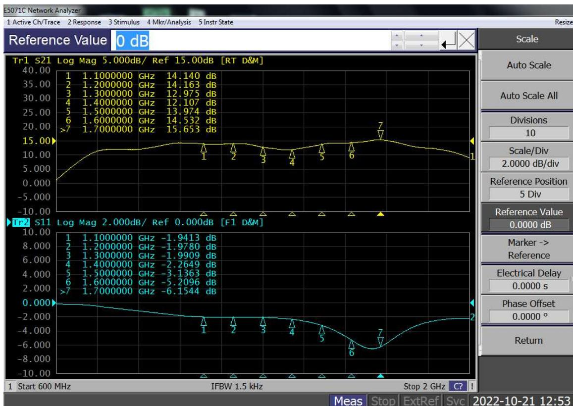
Figure 2. Network analyzer output S11/S21 (V<sub>DS</sub>=28V I<sub>DQ</sub>=150mA V<sub>GS</sub>=2.67V)
